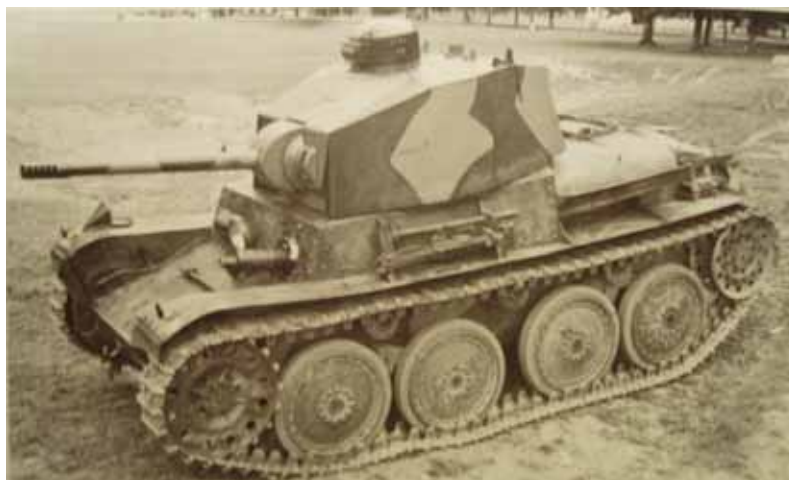
Abb. 16: Panzerwagen 39 mit versuchsweise eingebauter Pak 41 257
