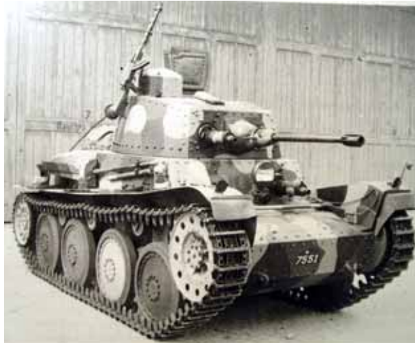
Abb. 15: Panzerwagen 39 mit aufgesetztem Lmg 25 als Flab Waffe 256
